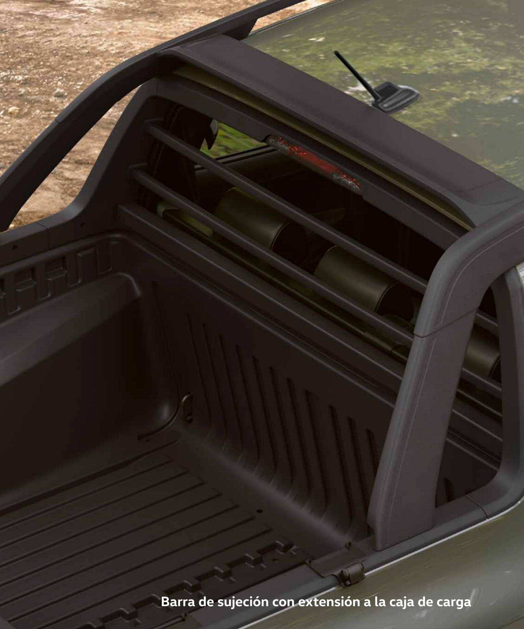
Barra de sujeción con extensión a la caja de carga
