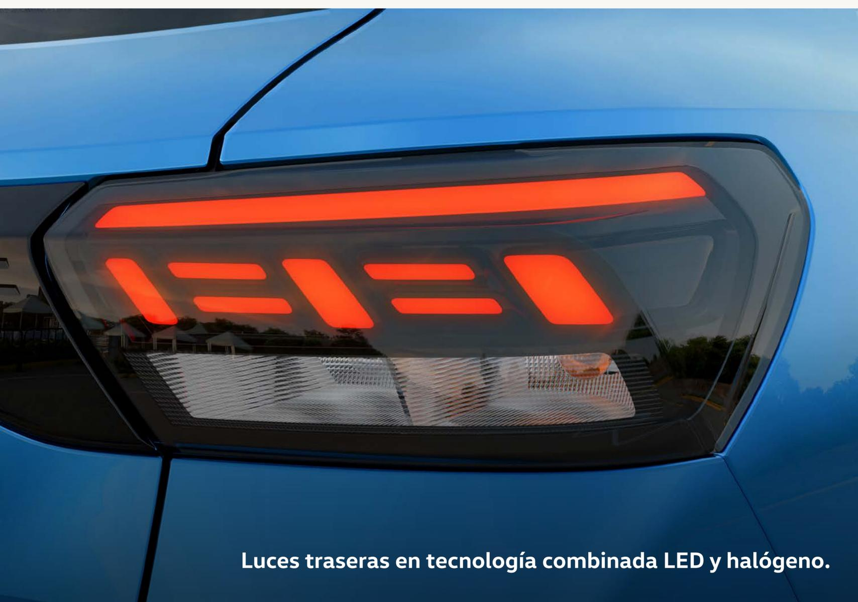
Luces traseras en tecnología combinada LED y halógeno.
